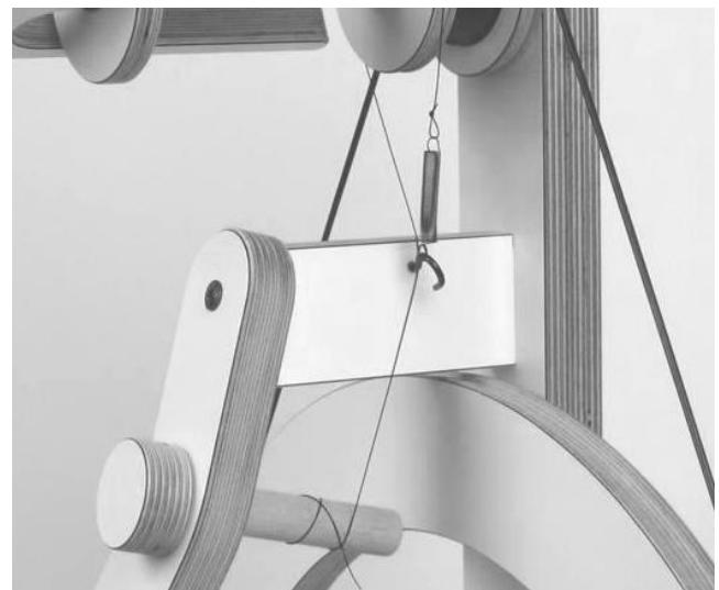
**DU** Die Feder sollte sich auf der linken Seite (wie im linken Bild) befinden, wenn sich das Rad beim Spinnen im Uhrzeigersinn dreht, und auf der rechten Seite, wenn du zwirnst.
